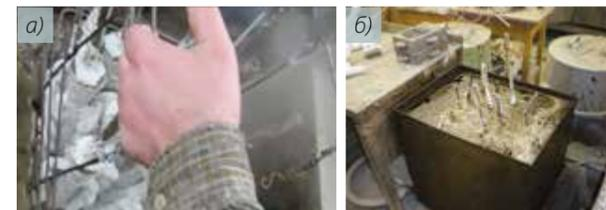
Рис. 7. Операция удаления модельного состава из формы, где:
