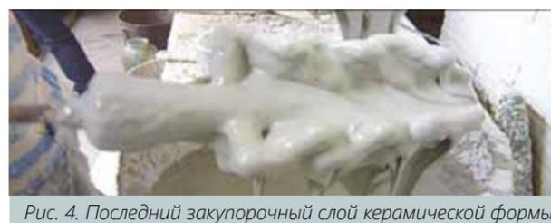
Рис. 4. Последний закупорочный слой керамической формы
