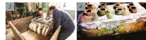
Рис. 3. Установка в контейнер вручную на песчаную постель кластера моделей с кондуктором на одном из предприятий КНР
