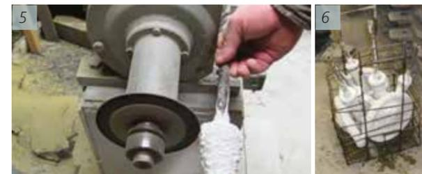
Рис. 5. Прорезка формы перед удалением модельного состава
