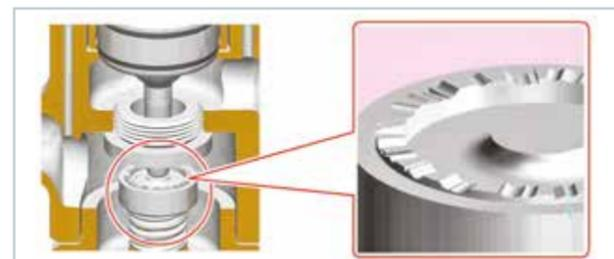
Рис. 5. Эрозия седла клапана от влажного пара
