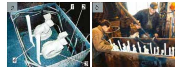
Рис. 2. Установка моделей в контейнер при формовке: а – двух моделей с опорами для устойчивости; б – одиннадцати моделей с поддержкой вручную (фото из цеха ФТИМС НАНУ)
